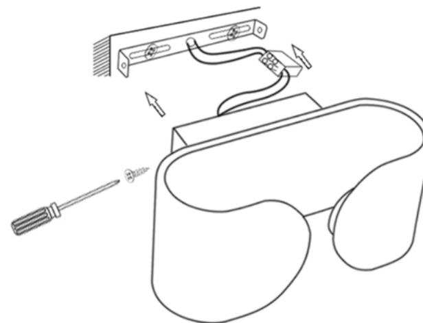
4) Fissare la plafoniera alla piastra di fissaggio con le viti e avvitare saldamente su entrambi i lati
