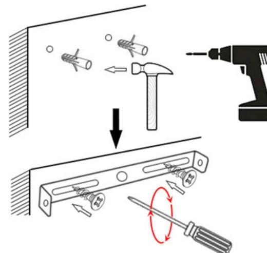
2) In base alla dimensione della piastra di installazione, praticare due fori nella posizione corretta vicino ai cavi che provengono dalla parete. Inserire i tasselli nei fori, quindi fissare alla parete la piastra di installazione avvitando saldamente.
